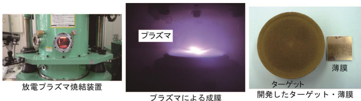
図1: 焼結技術および成膜技術を用いたジルコニウム系硬質膜の開発
